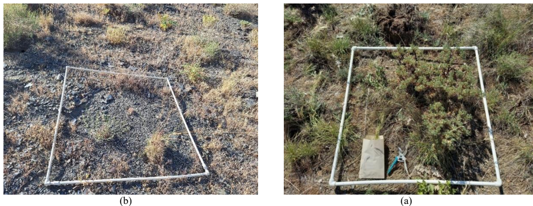
شکل ۵- اندازه‌گیری پوشش سطح زمین با استفاده از پلات گذاری در نقاط نمونه‌برداری (a) NF-T3 زیرحوضه نمونه و (b) SF-T2 زیرحوضه شاهد
