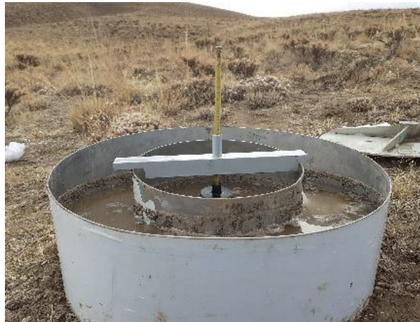
شکل ۴- آزمایش نفوذپذیری به‌وسیله استوانه مضاعف در نقطه نمونه‌برداری NF-T1 زیرحوضه نمونه Fig. 4. Double ring infiltration test at sampling point NF-T1, treated watershed
