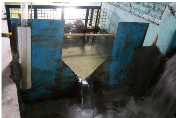
شکل ۵- سرریز مثلثی برای اندازه‌گیری بده خروجی Fig. 5. Triangular weir for measuring outflow discharge
