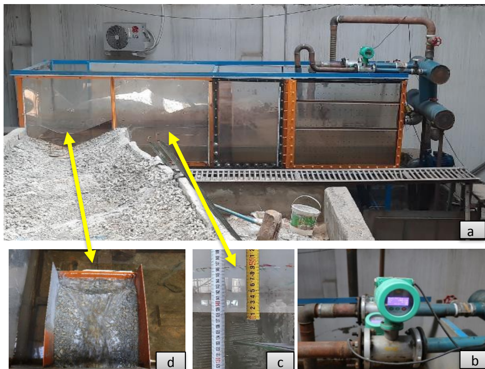
شکل ۲- اجزای بالادست مدل فیزیکی در فلوم بتونی، الف) مخزن فلزی شامل ب) فلومتر، پ) اشل اندازه‌گیری سطح آب در مخزن، ت) ادامه توپوگرافی مدل فیزیکی
