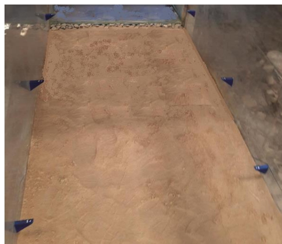
ب- مخزن رسوب ایجاد شده در بالادست سطح شیب‌دار فلزی b. Sediment box located upstream of the inclined metal structure
