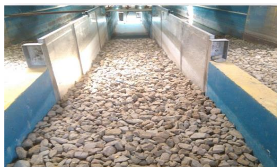
ب- کانال یک متری انجام آزمایش و سازه مستهلک کننده انرژی در انتهای آن
