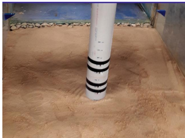
شکل ۴- نصب شمع در داخل مخزن رسوب پس از تعیین محل دقیق شکست موج Fig. 4. Installation of the pile inside the sediment tank after determining the exact location of the wave break
