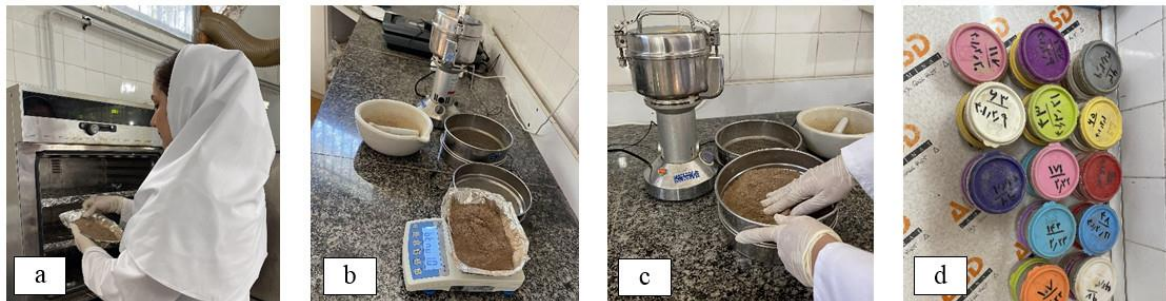
شکل ۲- مراحل آماده‌سازی نمونه‌های خاک در آزمایشگاه: a: قرار دادن نمونه در کوره، b: توزین نمونه، c: آسیاب و عبور از الک ۶۳ میلی‌متری، d: قرار دادن نمونه‌ها در ظروف نگین
