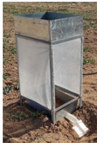
شکل ۱- نمایی از اجزای دستگاه شبیه‌ساز باران و شیوه نمونه‌برداری
