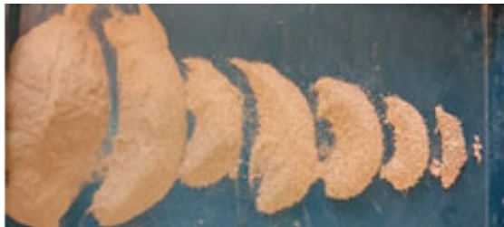
شکل ۲- نمایی از تعیین دانه‌بندی ذرات رسوب
