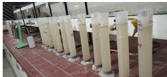
شکل ۲- نمایی از تعیین دانه‌بندی ذرات رسوب
