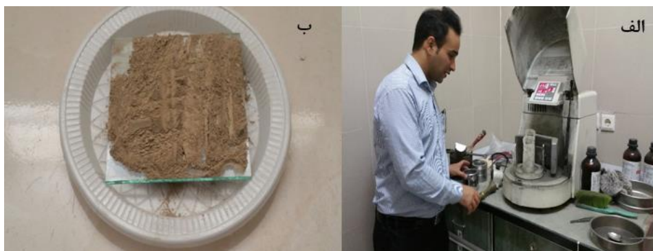
شکل ۴- نمایی از دستگاه آسیاب گلوله‌ای سیاره‌ای مورد استفاده (الف) و نمونه‌های پودر شده (ب)
