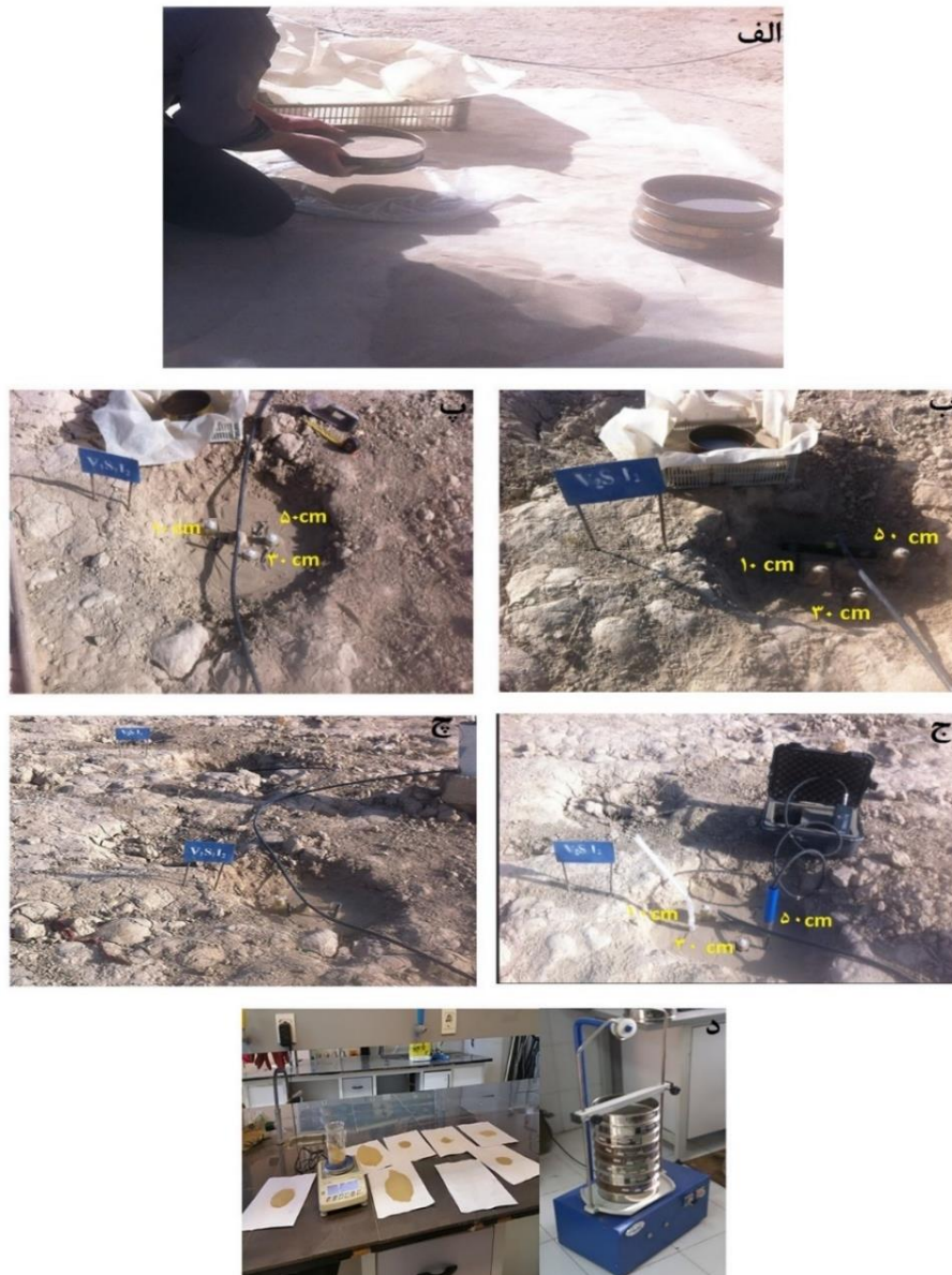
شکل ۷- نمایی از آماده‌سازی تیمارهای مورد بررسی و اندازه‌گیری دما و رطوبت در خاک تیمارهای مورد بررسی، الف) جداسازی ذرات ماسه بادی با استفاده از الک، ب) قبل از آماده‌سازی تیمار (خاکپوش ماسه بادی)، پ) بعد از آماده‌سازی تیمار (خاکپوش ماسه بادی)، ج) نحوه اندازه‌گیری رطوبت خاک و دما با استفاده از TDR و ترمومتر، چ) نحوه آبیاری در تیمارها و مخزن آب و د) اندازه‌گیری وزن ذرات نمونه‌های خاک برداشتی بر اساس روش الک خشک
