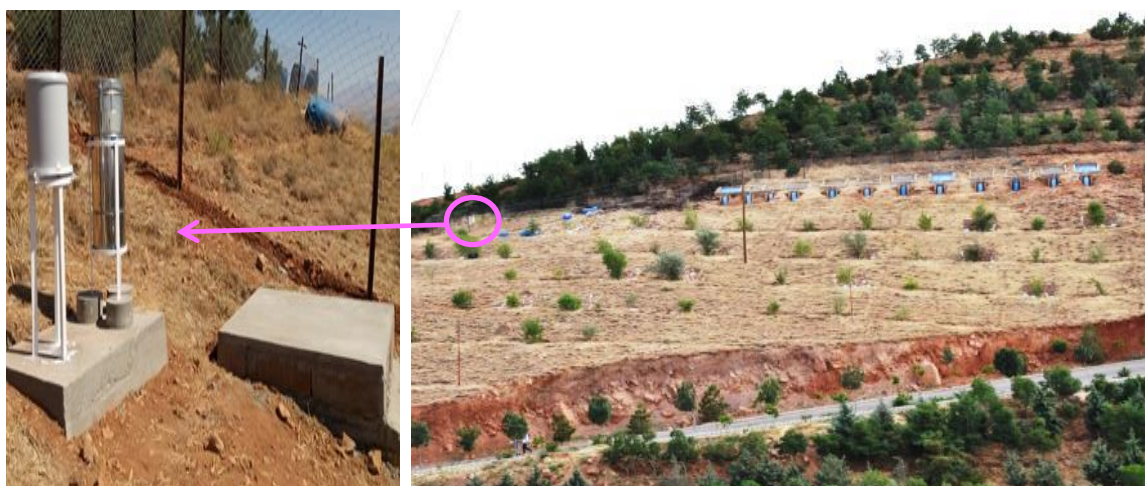
شکل ۲- نمای واقعی از کرت‌های سطوح آبگیر باران و ایستگاه باران‌سنجی
