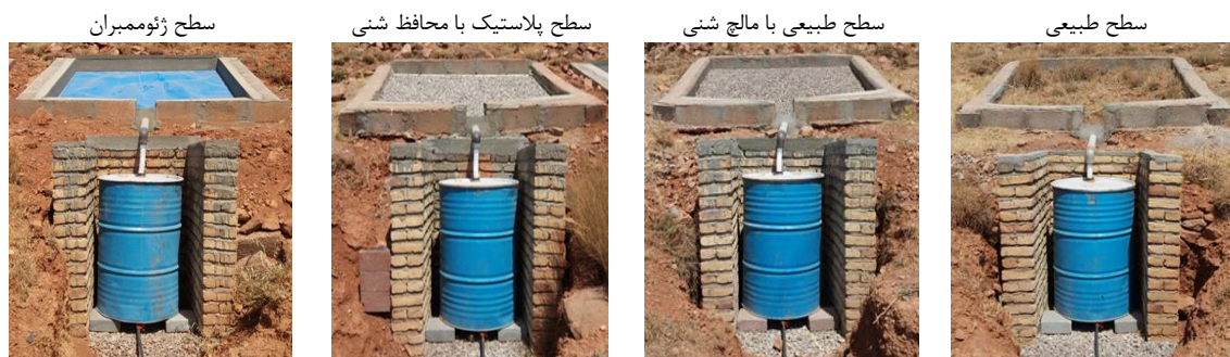
شکل ۳- سامانه‌های مختلف سطوح آبخیز باران مجهز به مخزن ذخیره رواناب
