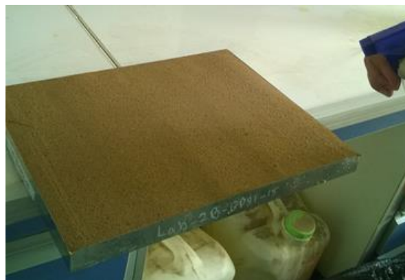
شکل ۳- مالچ‌پاشی نمونه با پلیمر
