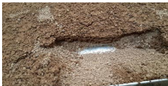
شکل ۶- نمایی از عمق نفوذ تثبیت‌کننده‌ها در خاک
