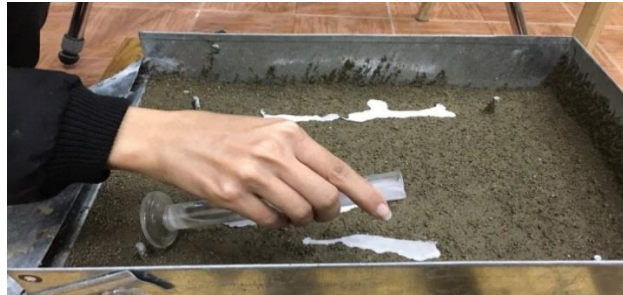
شکل ۳- نمایی از نحوه استفاده از پارافین برای اندازه‌گیری حجم هدررفت خاک ناشی از فرسایش شیاری
