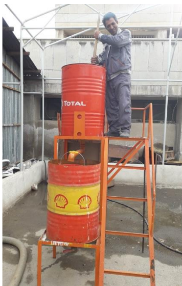
شکل ۱- استفاده از دو بشکه ۲۲۰ لیتری برای شبیه‌سازی انتقال رواناب و رسوب
