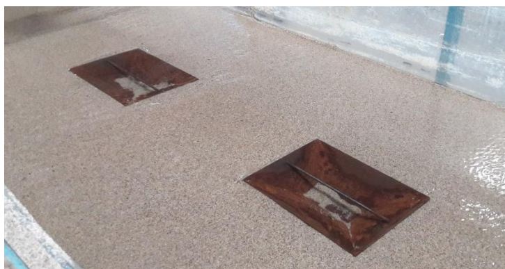
شکل ۲- قالب فلزی برای تعبیه حفره‌ها قبل از شروع آزمایش
