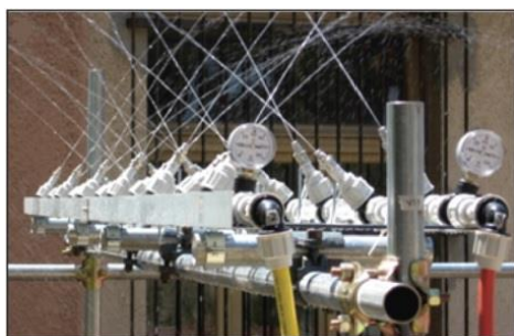
شکل ۱- نمونه دستگاه شبیه‌ساز باران با تکنولوژی نازل‌های پخش آب
