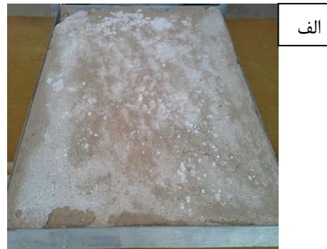
شکل ۲- خاک‌پوش آهکی، الف) قبل از انجام تست تونل باد و ب) بعد از انجام تست تونل باد
