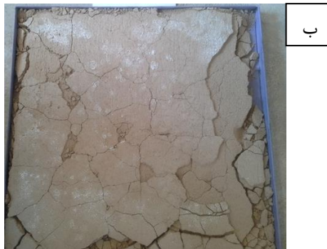
شکل ۲- خاک‌پوش آهکی، الف) قبل از انجام تست تونل باد و ب) بعد از انجام تست تونل باد
