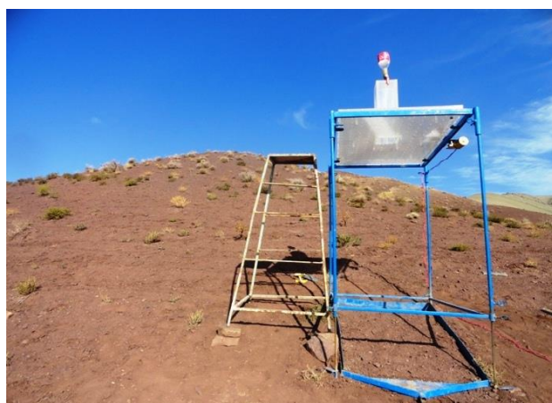
شکل ۲- تصویری از دستگاه شبیه‌ساز باران مورد استفاده بر روی لیتولوژی مارنی از سازند مارن قرمز ائوسن (Eom) در حوضه مورد بررسی
