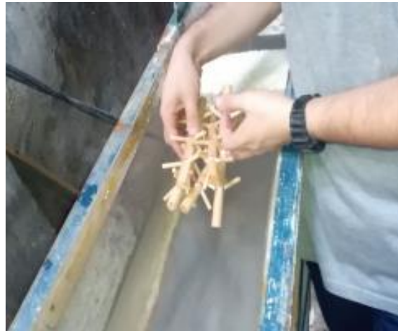
شکل ۶- رهاسازی الوار در بالادست پل
