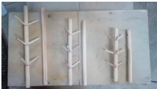
شکل ۵- الوار استفاده شده در مدل آزمایشگاهی و تفکیک آن‌ها از نظر ابعاد و شاخه‌دار و بدون شاخه بودن
