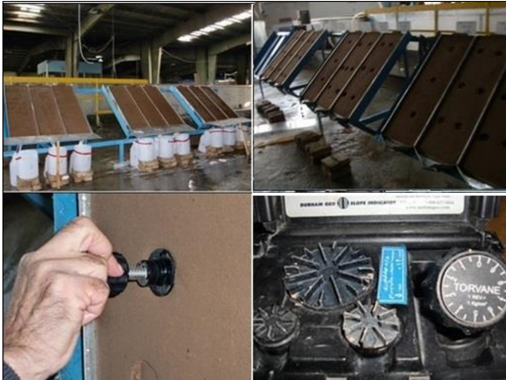
شکل ۲- نمایی از نحوه شبیه‌سازی بارش روی تیمارها، ابزار جمع‌آوری رواناب و رسوب و دستگاه اندازه‌گیری مقاومت برشی
