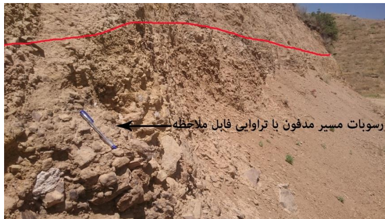
شکل ۱۳- نحوه رسوب‌گذاری در ترانشه کنار جاده در نزدیکی تکیه‌گاه راست
