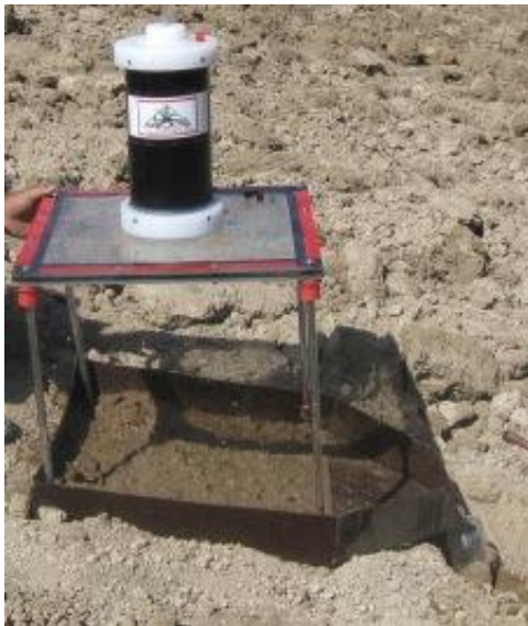
شکل ۴- نمائی از باران‌ساز متحرک صحرائی
