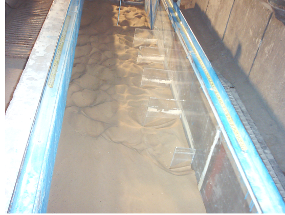
شکل ۱- فلوم آزمایشگاهی و تجهیزات مربوطه
