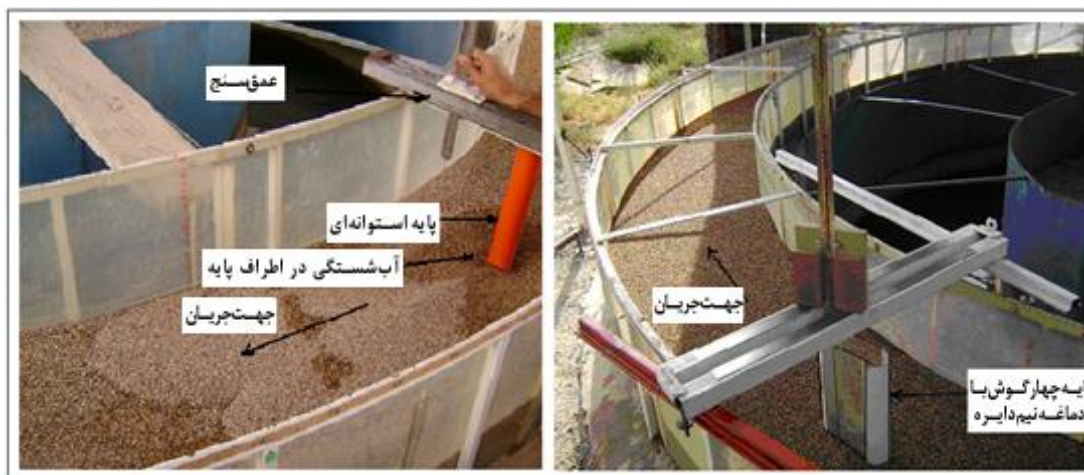
شکل ۵- فروافتادگی و رسوب‌گذاری در پایین‌دست پایه‌های استوانه‌ای و مقطع چهارگوش با دماغه نیم‌دایره به دلیل انحراف جریان
