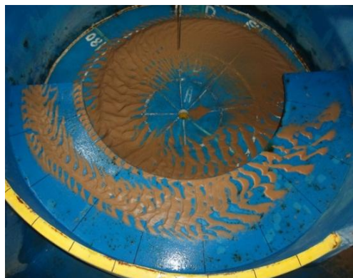
شکل ۱۰- آزمایش‌های مقدماتی تزریق رسوب در حالت بدون صفحه
